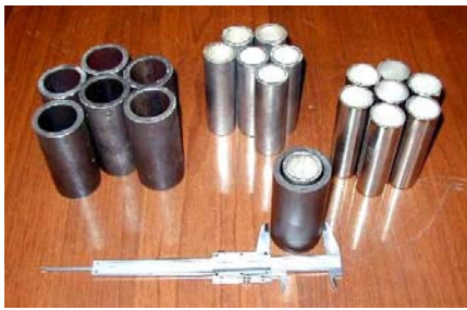
شکل ۶. به ترتیب از چپ: کربنی، ضدزنگ رده ۴۰ و رده ۵
