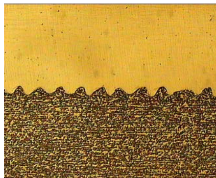
شکل ۹، فصل مشترک دو لوله (لوله پرنده رده ۵) (۳۰ برابر)
